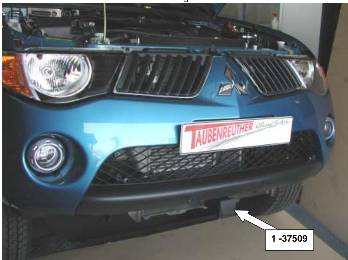
Hier sehen sie die fertig montierte Frontaufnahme.
