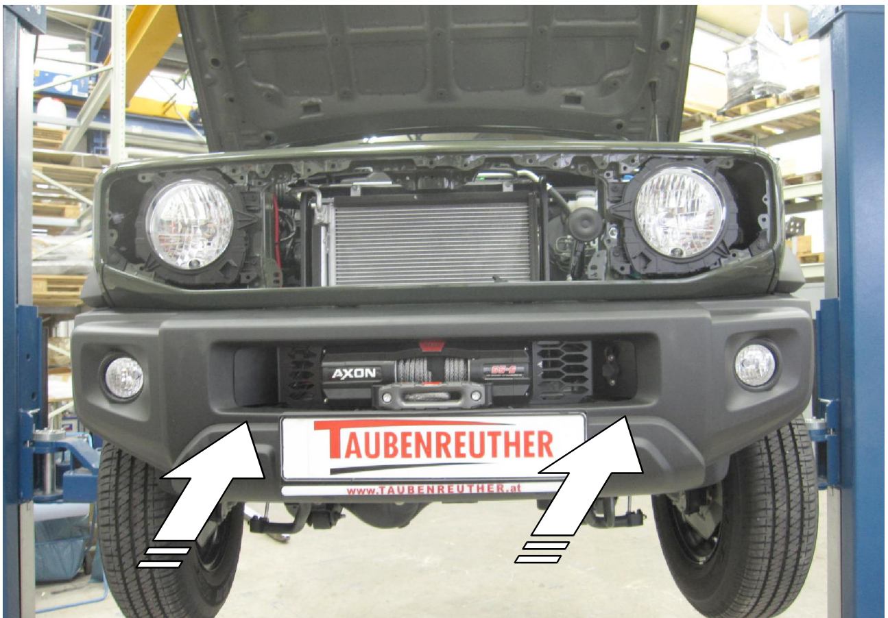
21 Stoßfänger wieder montieren! / Mount the bumper again!
