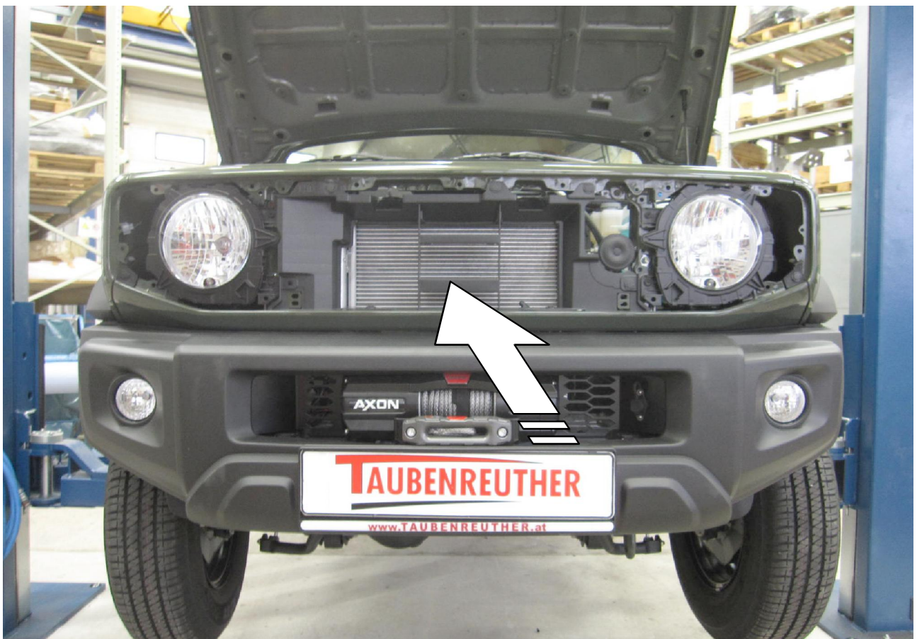
22 Rahmen wieder montieren! / Mount the frame again!
