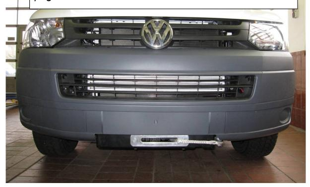
Hier sehen sie den fertig montierten Seilwindenanbausatz. Bevor sie mit der Montage beginnen lesen sie bitte diese Anleitung und das Benutzerhandbuch der Seilwinde gut durch.
