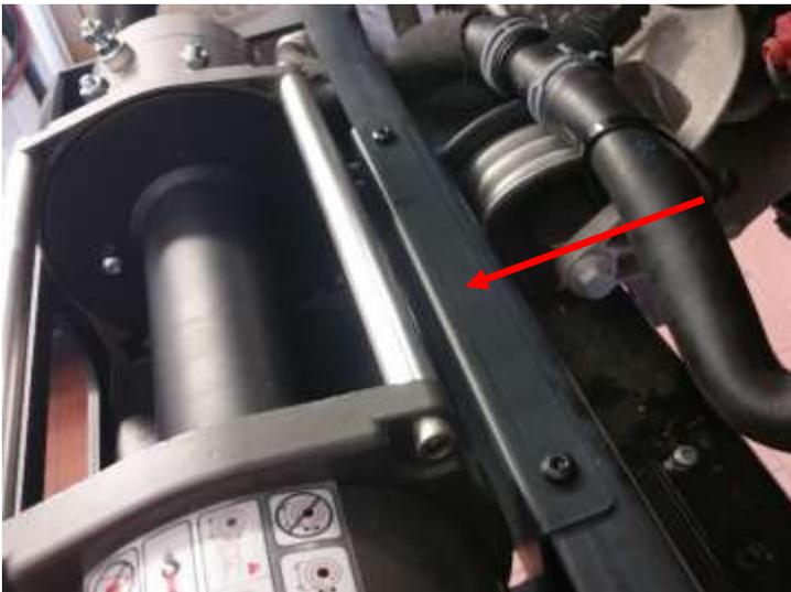
Das mitgelieferte Winkelblech zur Kabelführung hinter der Winde am Windenhalter mit den beiden mitgelieferten Torx-Schrauben M6x10 befestigen. Die beiden Schrauben mit 10 Nm festziehen.
