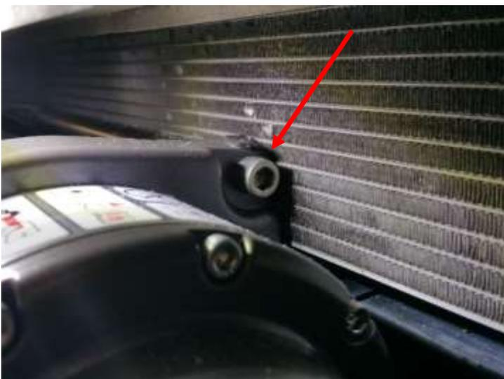
Falls der Kühler sehr knapp an der Winde ist, dann einen Scheuerschutz, z.B. aus Filz an der Winde anbringen um das Kühlernetz zu schützen.
