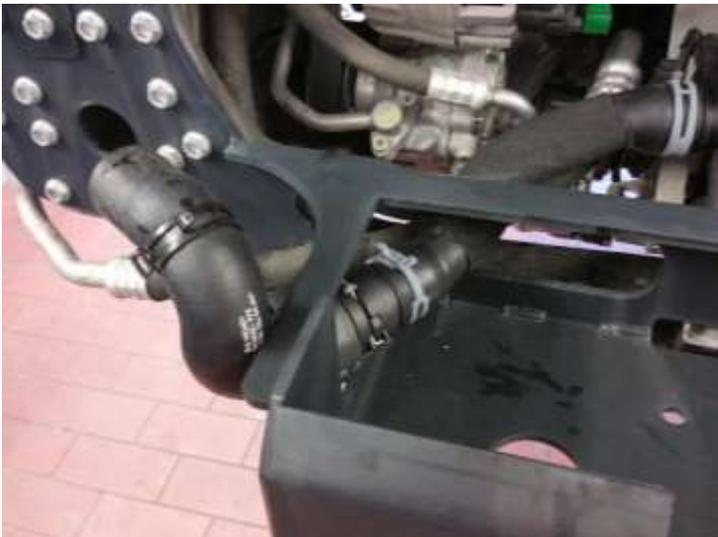
Der zuvor abgetrennte kurze Schlauchbogen wie im Bild zu sehen ist wieder mit dem langen Schlauchstück verbinden.
