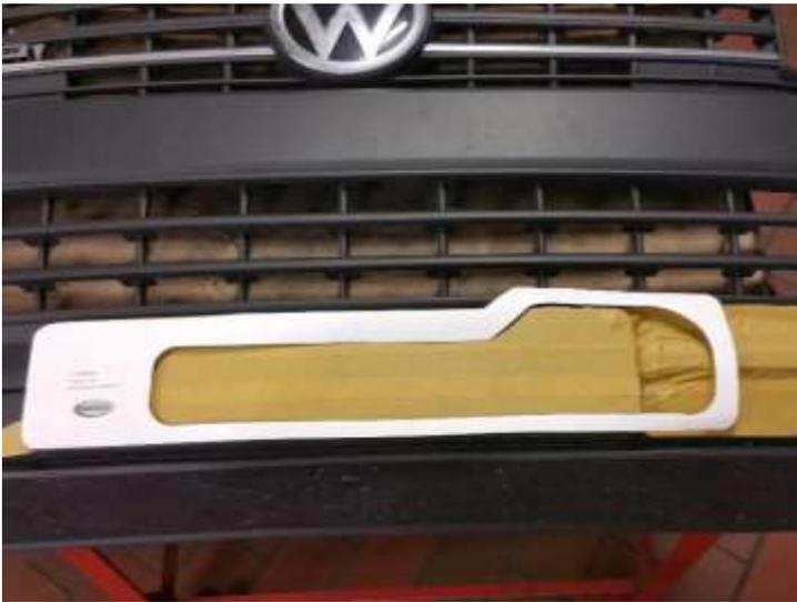
Den Stoßfänger im Bereich der Kennzeichenfläche mit einem Klebeband abkleben und den Ausschnitt für das Seilfenster mittels der mitgelieferten Schablone auf dem Stoßfänger anzeichnen.
