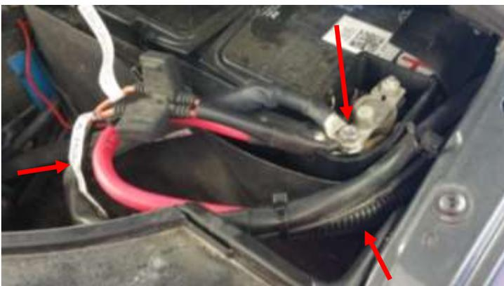
Das plus Kabel am Pluspol der Fahrzeugbatterie anschließen.
