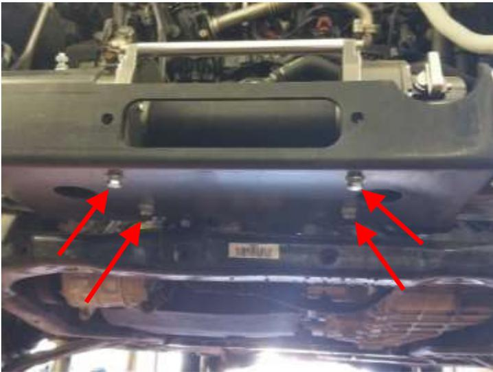
Die 4 Befestigungsschrauben der Winde mit 55 Nm festziehen.
