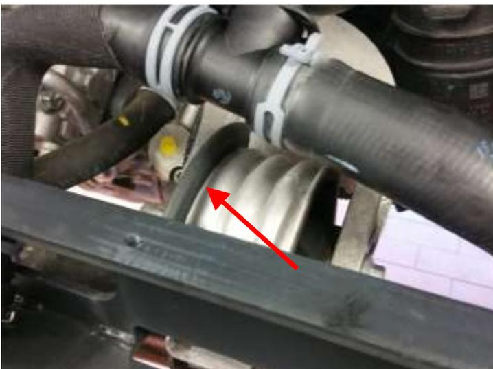
Den mitgelieferten Kantenschutz auf der rechten Blechkante des vorderen Motorlagers montieren.
