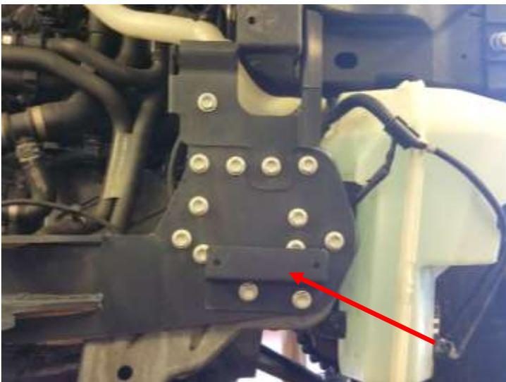
Wie im Bild zu sehen wird der mitgelieferte Halter für das Steuergerät links unten am Windenhalter montiert. Abschließend alle montierten M8 Schraubverbindungen mit 25 Nm festziehen
