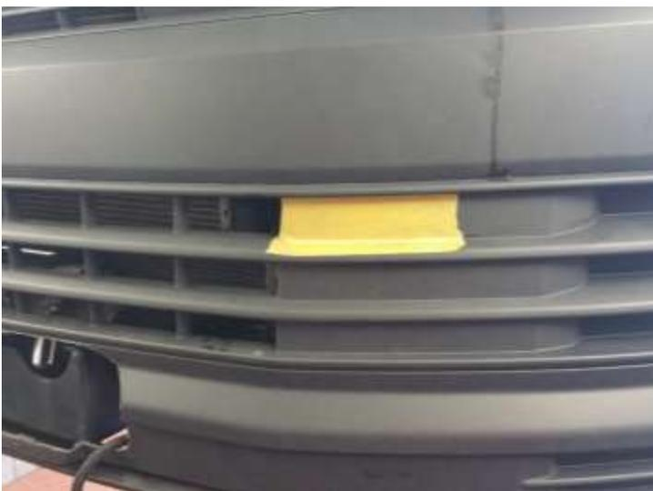
Für die Durchführung des Anschlusses der Windenfernbedienung wird der Stoßfänger wie im Bild zu sehen ist abgeklebt.
