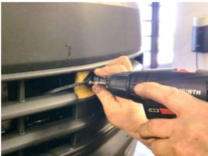
Die Buchse von außen durch das Loch stecken und die Laschen mit den Befestigungslöchern ausrichten. Anschließend die Befestigungslöcher durch Bohren in den Stoßfänger übertragen.
