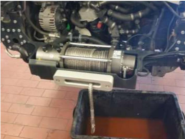
Das mitgelieferte Seilfenster mittels der zwei Senkkopfschrauben M10x40 am Windenhalter befestigen und mit 35 Nm festziehen.
