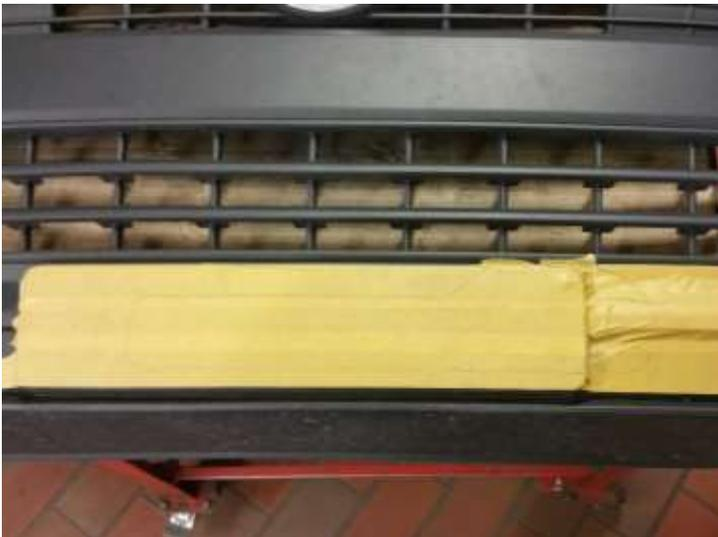
Den angezeichneten Ausschnitt mit Werkstattmitteln aus dem Stoßfänger ausschneiden. Anschließend den Stoßfänger am Fahrzeug montieren.
