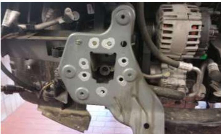
Alle gebohrten Löcher entgraten und wie auf Seite 2 beschrieben gegen Korrosion schützen.
