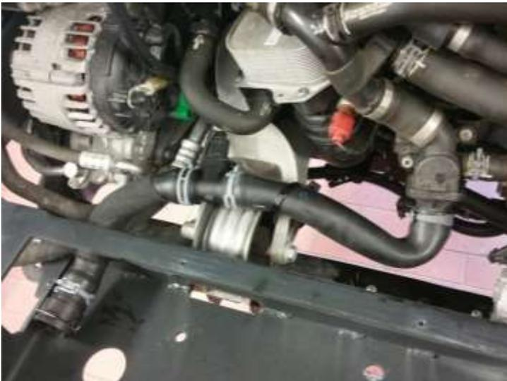
Den mitgelieferten und vormontierten Kühlwasserschlauch an der Kupplung trennen und das längere Stück wie im Bild zu sehen ist gegen den im Fahrzeug verbauten Schlauch austauschen.
