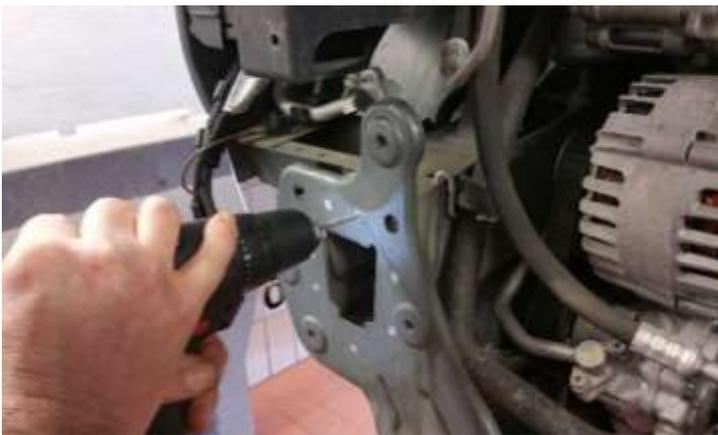
Die Angezeigten Punkte vorbohren und auf 10 mm aufbohren.
