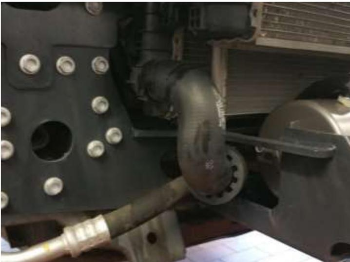
Den linken Scheinwerfer und alle Kühler wieder einbauen und alle Schlauchverbindungen anschließen.
