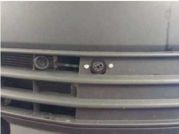
Die Kontur des Steckers aus dem Stoßfänger ausschneiden und die Buchse wieder von innen am Stoßfänger montieren.
