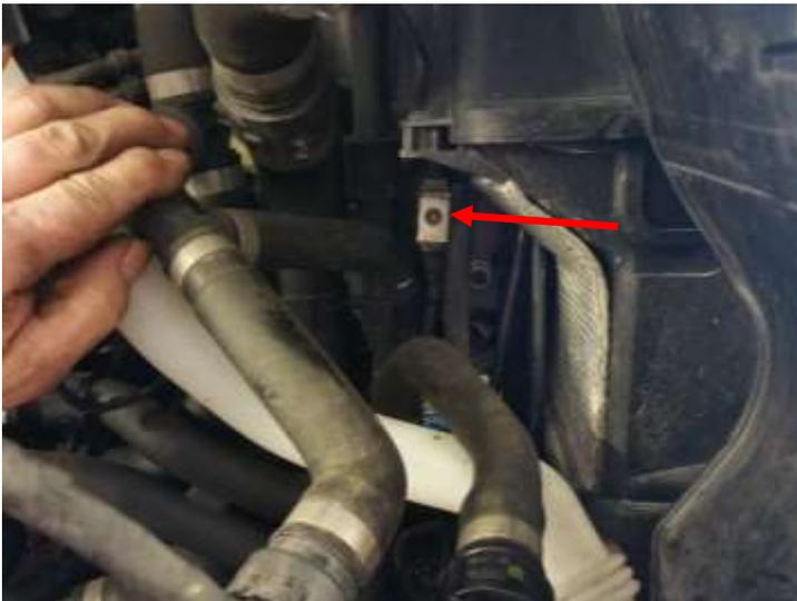
Das Massekabel an dem Massepunkt befestigen, der sich wie auf dem Bild zu sehen ist oberhalb des linken Fahrzeugrahmens befindet.
