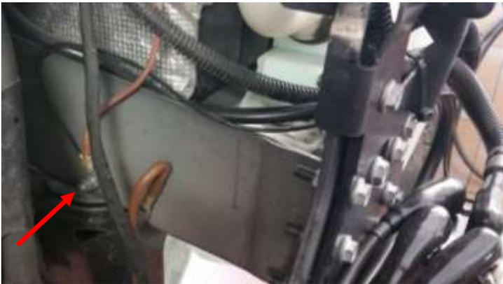
Das Massekabel des Steuergerätes am Massepunkt am Fahrzeugrahmen befestigen.
