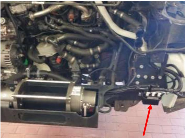
Das mit allen Kabeln vormontierte Steuergerät für die Winde an dem zuvor montierten Halter befestigen und die drei dicken Kabel, wie in der Einbauanleitung der Seilwinde beschrieben, an der Seilwinde anschließen.
