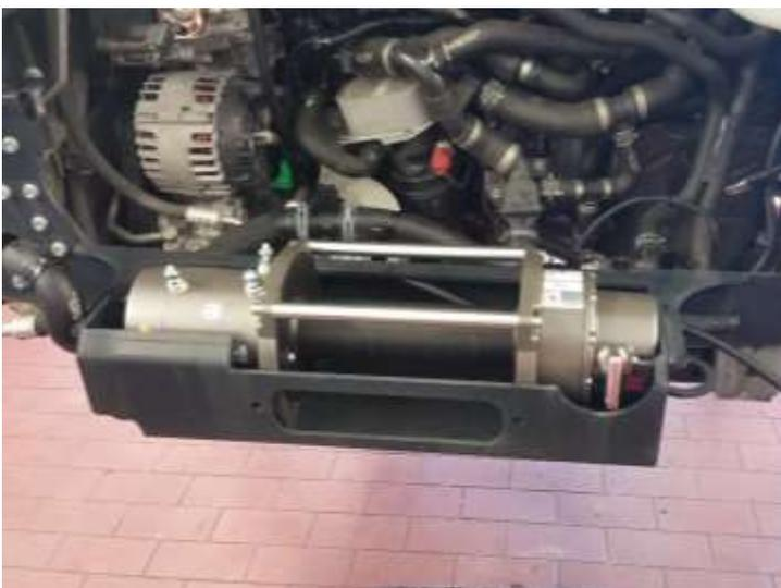
Die beim Kit 1214 0000 mitgelieferte Winde inkl. Massekabel in den Windenhalter einsetzen und befestigen. Das Massekabel auf der linken Seite aus dem Windenhalter führen.
