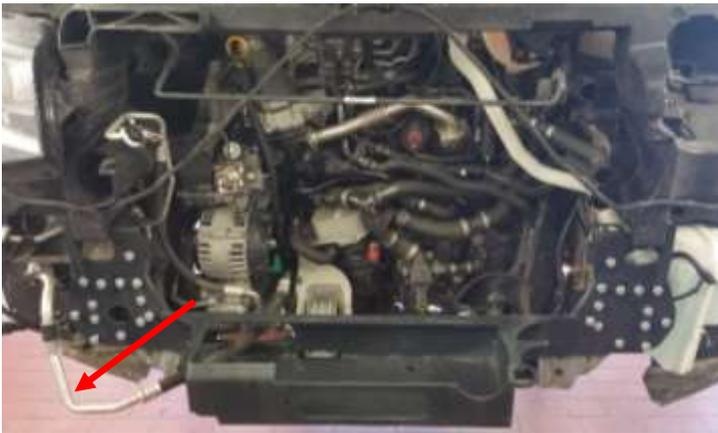
Den Windenhalter zusammen mit dem linken und rechten Halter für das Kühlerpaket an den Rahmenköpfen befestigen. Zur Befestigung werden die 26 mitgelieferten Sechskantschrauben M8x35 und Sechskantstopfmuttern M8 verwendet.
