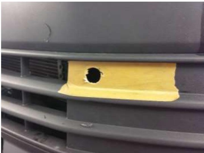
Mittels Stufenbohrer das angezeichnete Loch auf den Durchmesser der Buchse aufbohren.
