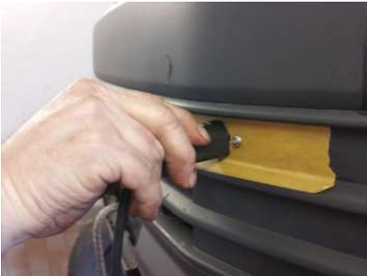
Die Buchse von innen am Stoßfänger montieren und von außen die Kontur des Steckers am Stoßfänger anzeichnen.
