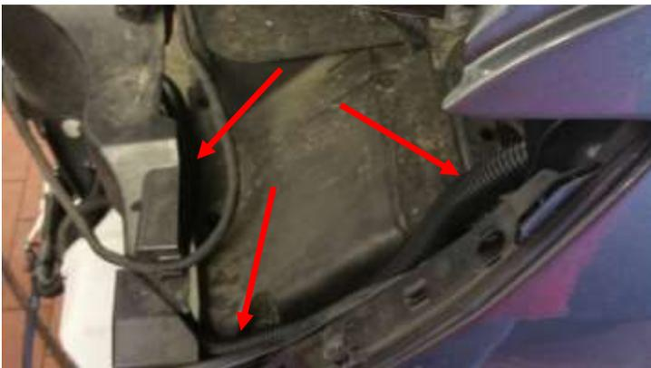
Das plus Kabel im Wellrohr unterhalb der Scheinwerferposition nach links zum Kotflügel und am Kotflügel entlang nach oben zur Fahrzeugbatterie verlegen.
