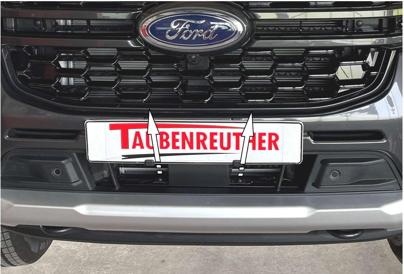
**1**      **Schrauben des Radarsensors lösen!**
