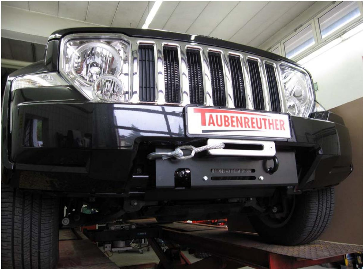
**Hier sehen sie den fertig montierten Seilwindenanbausatz.
