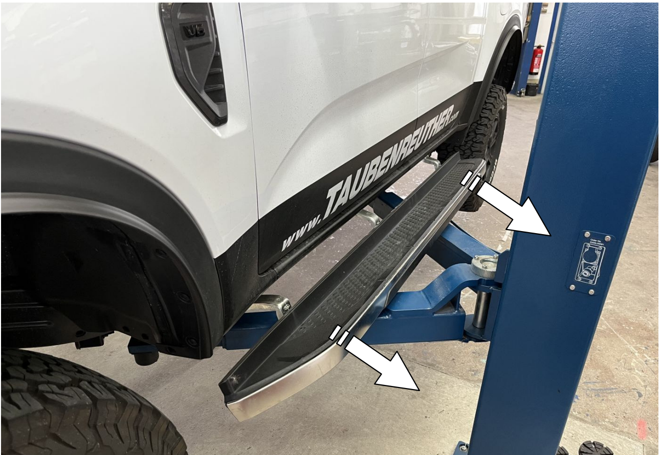
1 Original Trittbrett entfernen / Remove the original running board Das gleiche an der rechten Seite / Do the same on the right side
