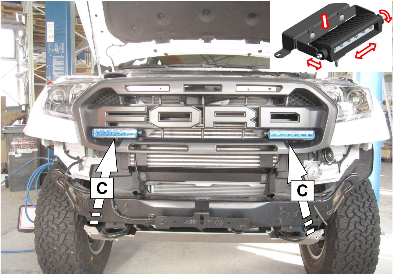
11 Scheinwerfer einbauen, nach Anleitung anschließen, ausrichten und festziehen! Install and connect the light bars according to instructions, adjust and tighten them!
