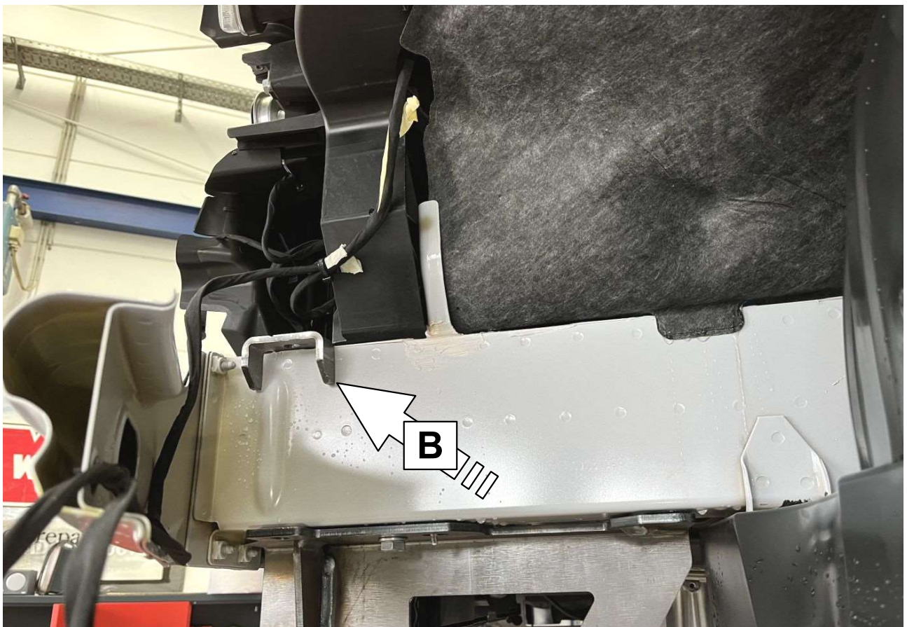
6 Zugwinkel vorne einhängen! / Hook in the tension angle at the front! Das Gleiche an der rechten Seite / The same at the right
