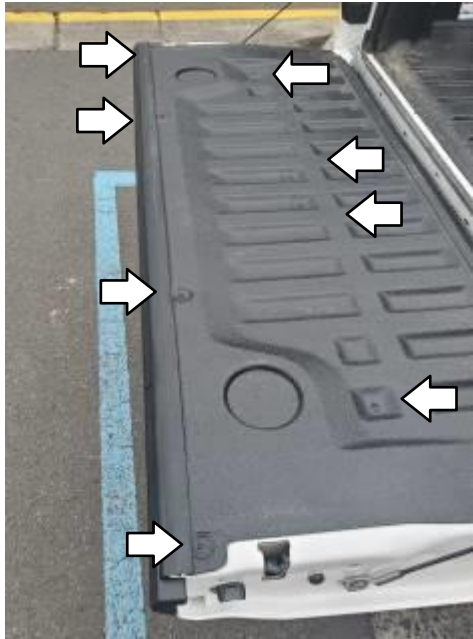
8 SCHRAUBEN DER HECKKLAPPENVERKLEIDUNG ENTFERNEN
