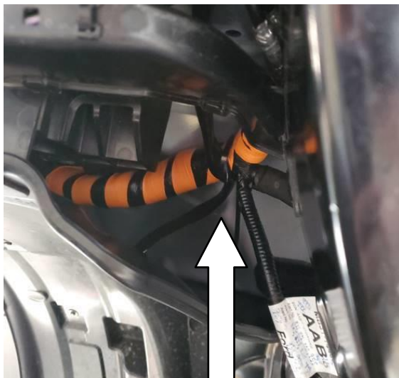
KABELBAUM HINTER DER LINKEN VORDEREN RADLAUFVERKLEIDUNG
