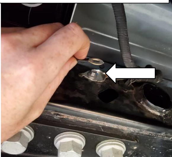
ERDUNGSKLEMME AN M6-SCHRAUBE AM CHASSIS BEFESTIGEN
