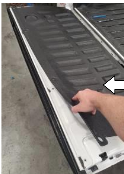
DIE GUMMIPROFILE DER AUSKLEIDUNG UND DER UNTEREN AUSKLEIDUNG AN IHREM PLATZ BELASSEN
