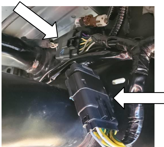
KABELBAUM AN DIE FAHRZEUGSTECKER ANSCHLIESSEN
