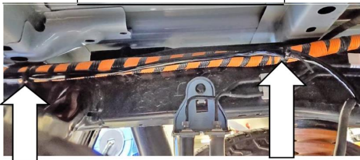
KABELBAUM ÜBER DIE LINKE FAHRGESTELL- SCHIENE MIT KABELBINDER FIXIEREN
