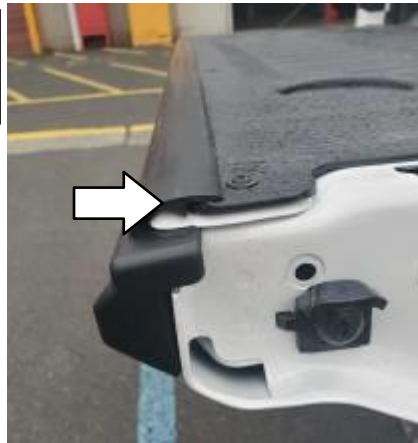
DAS OBERE GUMMIPROFIL VON DER HECKKLAPPE ENTFERNEN
