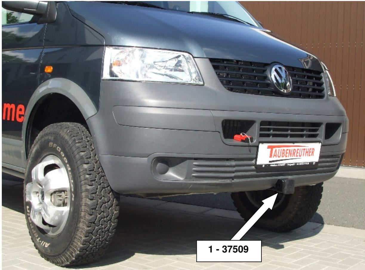
Hier sehen sie die fertig montierte Frontaufnahme.
