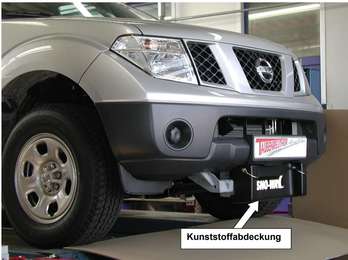
Hier sehen sie den fertig montierten Schneepflugabstützsatz.
