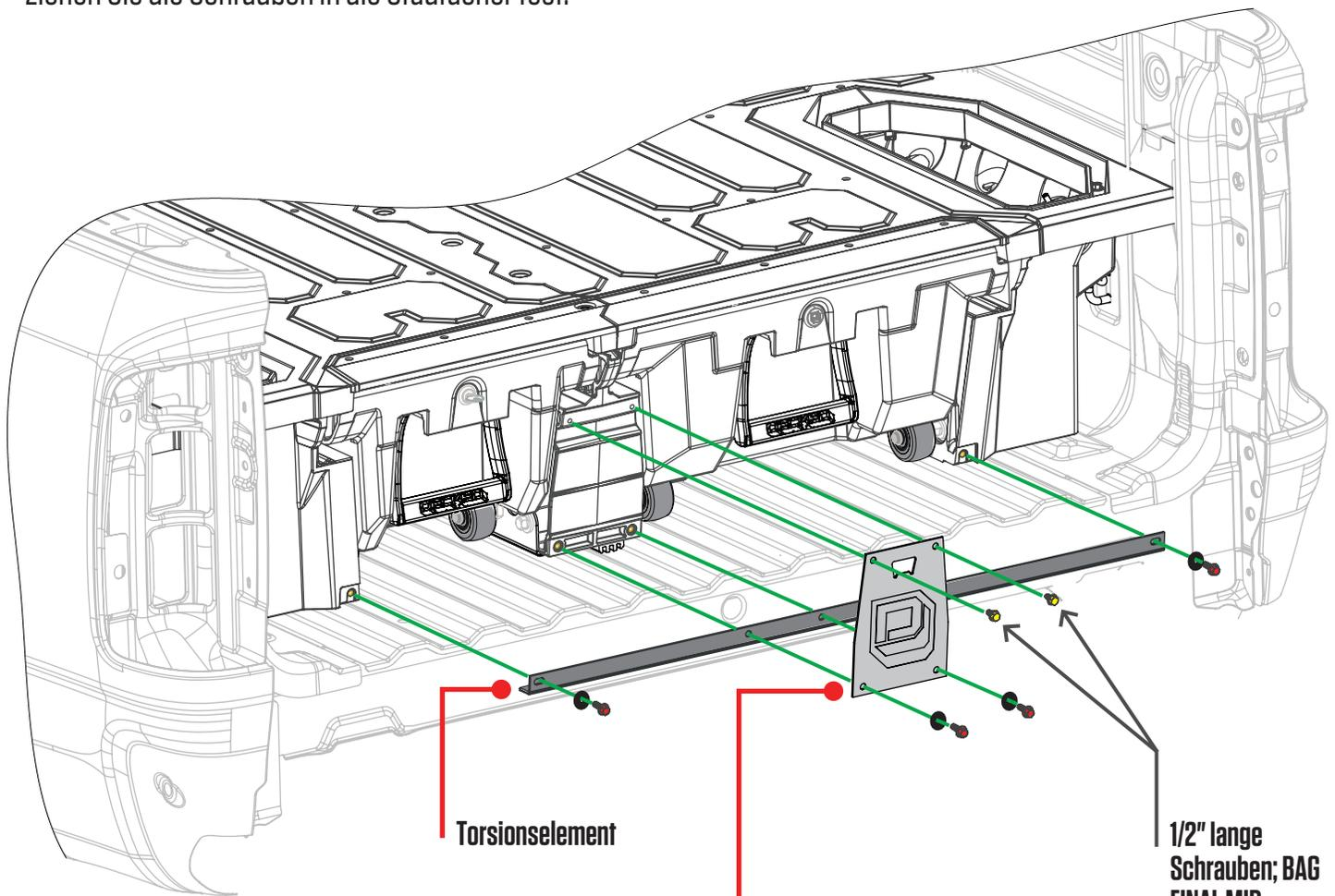
**TIPP:** Der Flaschenöffner wird außerhalb der Torsionselement angebracht.
