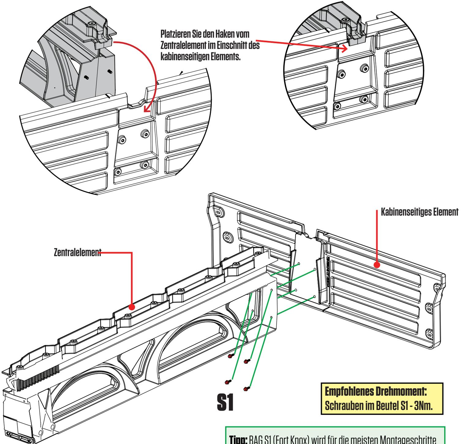
**Tipp:** BAG S1 (Fort Knox) wird für die meisten Montageschritte benötigt, also passen Sie auf, dass Sie nichts verlieren! Diese Schrauben sind in den Anweisungen in rot hervorgehoben.
