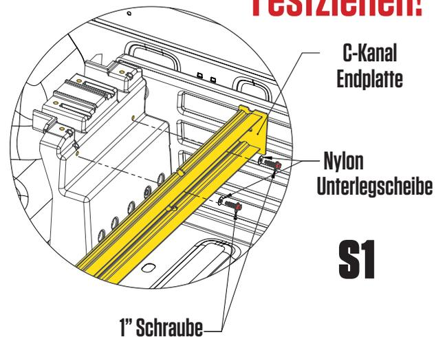
**Empfohlenes Drehmoment: Schrauben in S1 und S2 BAG - 3Nm.**
