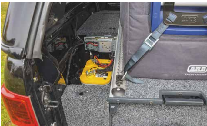
Die Optima-Verbraucher-Batterie ist über eine Abdeckung jederzeit erreichbar und aufgrund ihrer Lage neben den Outback-Schubladen gut geschützt.
