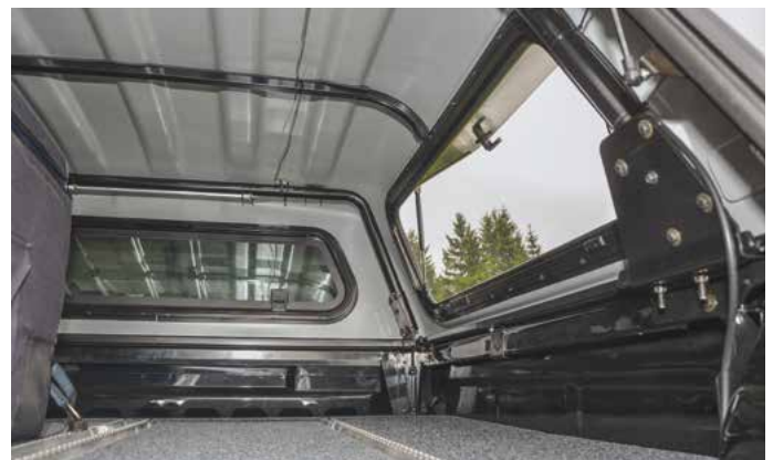
Dank innenliegender Stahlstreben wird die Dachlast nicht über das Hardtop, sondern über die Bordwände abgestützt.
