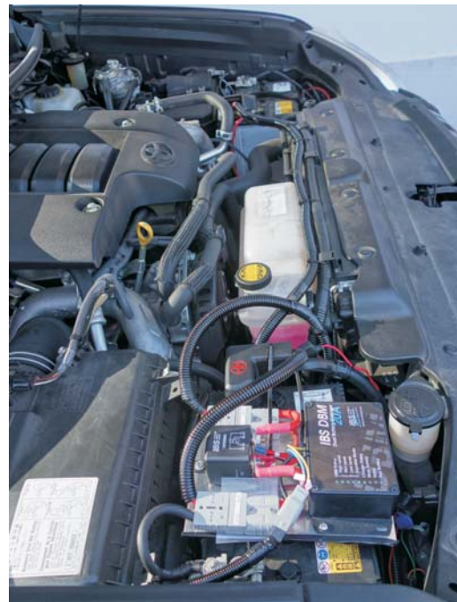
DBM20A Test-Installation mit IBS-DBS im Toyota LandCruiser 150
