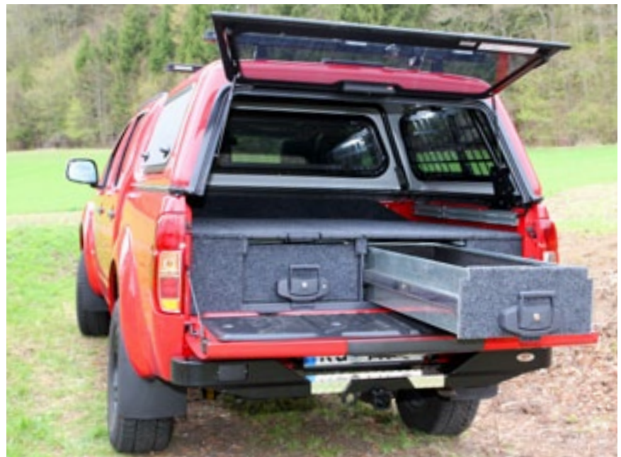
▲ Einfacher Laden: Leichter Zugang von der Seite mit der „Service-Klappe“ samt Aufstell-Dämpfern. Gegenüber ist ein Schiebefenster montiert.
