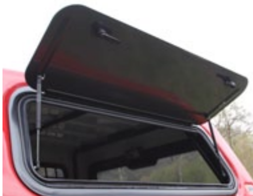
▲ Einfacher Laden: Leichter Zugang von der Seite mit der „Service-Klappe“ samt Aufstell-Dämpfern. Gegenüber ist ein Schiebefenster montiert.
