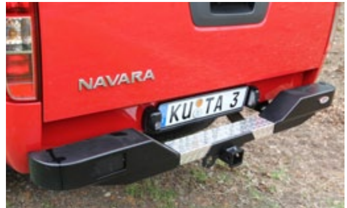
▲ Die Heckstoßstange aus Stahlblech ist robuster als das Serienteil. Die Vierkantaufnahme kann für Hängerkupplungen oder Seilwinden genutzt werden.
