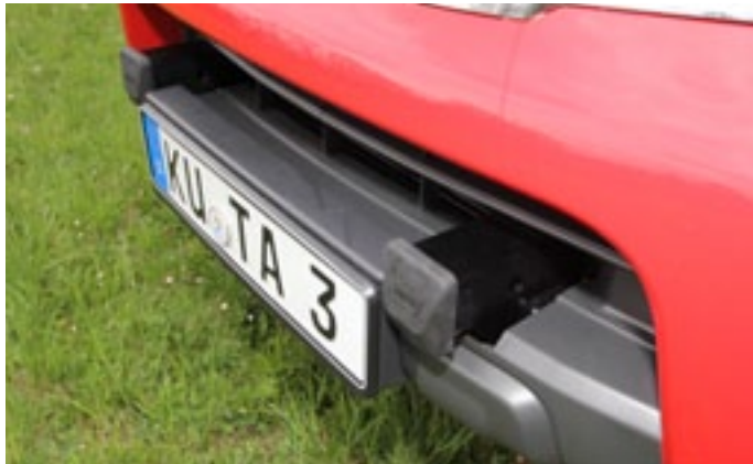
▲ Winden-Aufnahme: Wegen des Ladeluftkühlers ist beim V6 kein Platz für einen Festeinbau. Der Navara V6 bekommt deshalb das Multimount-System.
